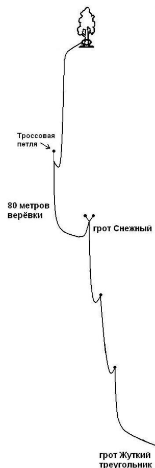
Навеска во входной колодец
